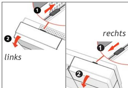
4. Die linke und die rechte Schraube oben auf dem ClimaRad nach innen schieben und beide Klappen öffnen, indem Sie diese in Ihre Richtung ziehen.
