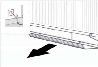
1. Den Stecker aus der Steckdose herausziehen und den Filtereinschub an der Unterseite des ClimaRad nach vorne ziehen.
