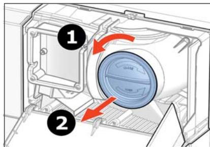
5. Die beiden blauen Stopfen eine Umdrehung gegen den Uhrzeigersinn drehen und entfernen.
