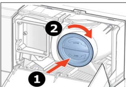
7. Die beiden blauen Filterstopfen wieder vollständig einsetzen und festdrehen, damit das Gerät ordnungsgemäß funktioniert.
