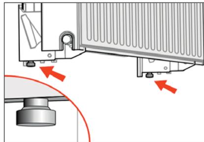
2. Unter den zwei (oder vier) Radiatorkonsolen befindet sich jeweils eine Sicherungsschraube. Drehen Sie diese Sicherungsschrauben vollständig heraus.
